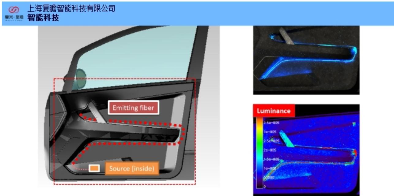
TracePro拥有完整成熟的操作界面，其直觉友善的设计架构，可以非常快速地让使用者熟悉软件的操作环境 $\square$ TracePro使用ASIC实体绘图引擎作为其CAD的运算核心，能轻易地新建或汇入光学模拟所需的固体模型。目前主流的CAD软件均有支持ACIS规格(SAT格式)，故其几何转档上的兼容性极高 $\square$ TracePro亦可支持IGES $\square$ STEP的几何文件格式，亦可汇入镜头设计文件(如OSLO $\square$ CodeV $\square$ ZEMAX $\square$ ACCOSV及Sigma)做后续光线追迹之用。
