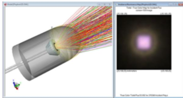
TracePro的RepTile Repetitive Tile 是一种即时创建表面的实用程序，可以在任何平面上定义并创建重复的微观结构 RepTile是一种方便易用的功能，它减少了构建和修改结构所花费的时间，并减少了光线追踪数以百万计的表面实体以进行照明和显示背光分析的时间。
